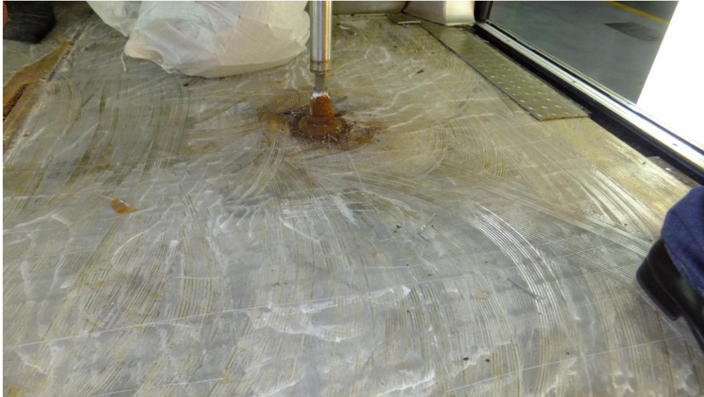
圖 3 拆下車廂立柱
