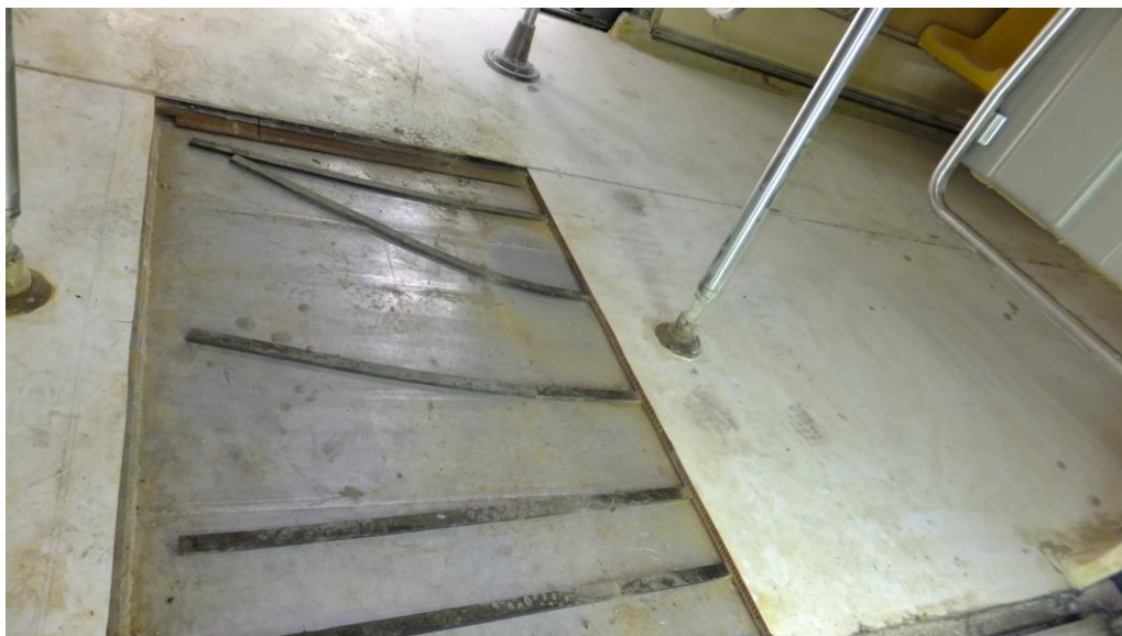
圖 5 切除原車蜂巢結構板
