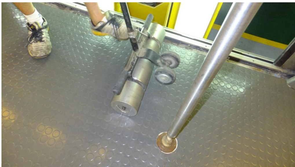
圖 8 以滾輪滾壓橡膠地板
