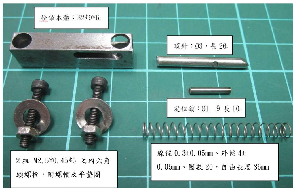
圖 3、彈簧式栓鎖零件圖
